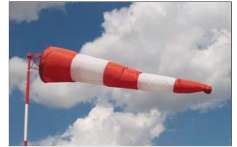
▲ Manche à air permettant de connaître visuellement la direction et la force du vent.
