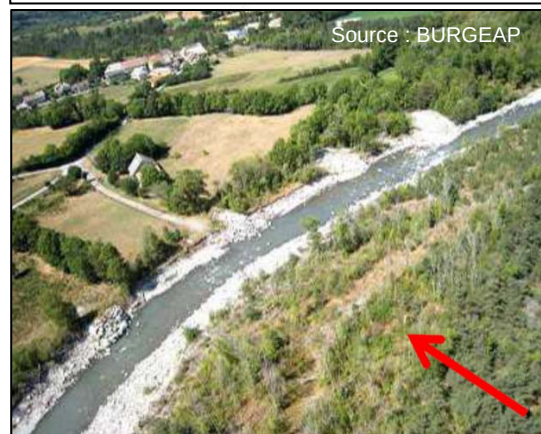
Photo 3 : Le Drac à Saint-Bonnet-en-Champsaur (Hautes-Alpes) : dépérissement de la forêt alluviale par abaissement de la nappe.
